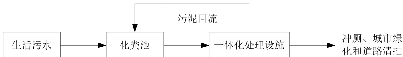
图9. 生活污水处理工艺流程图
