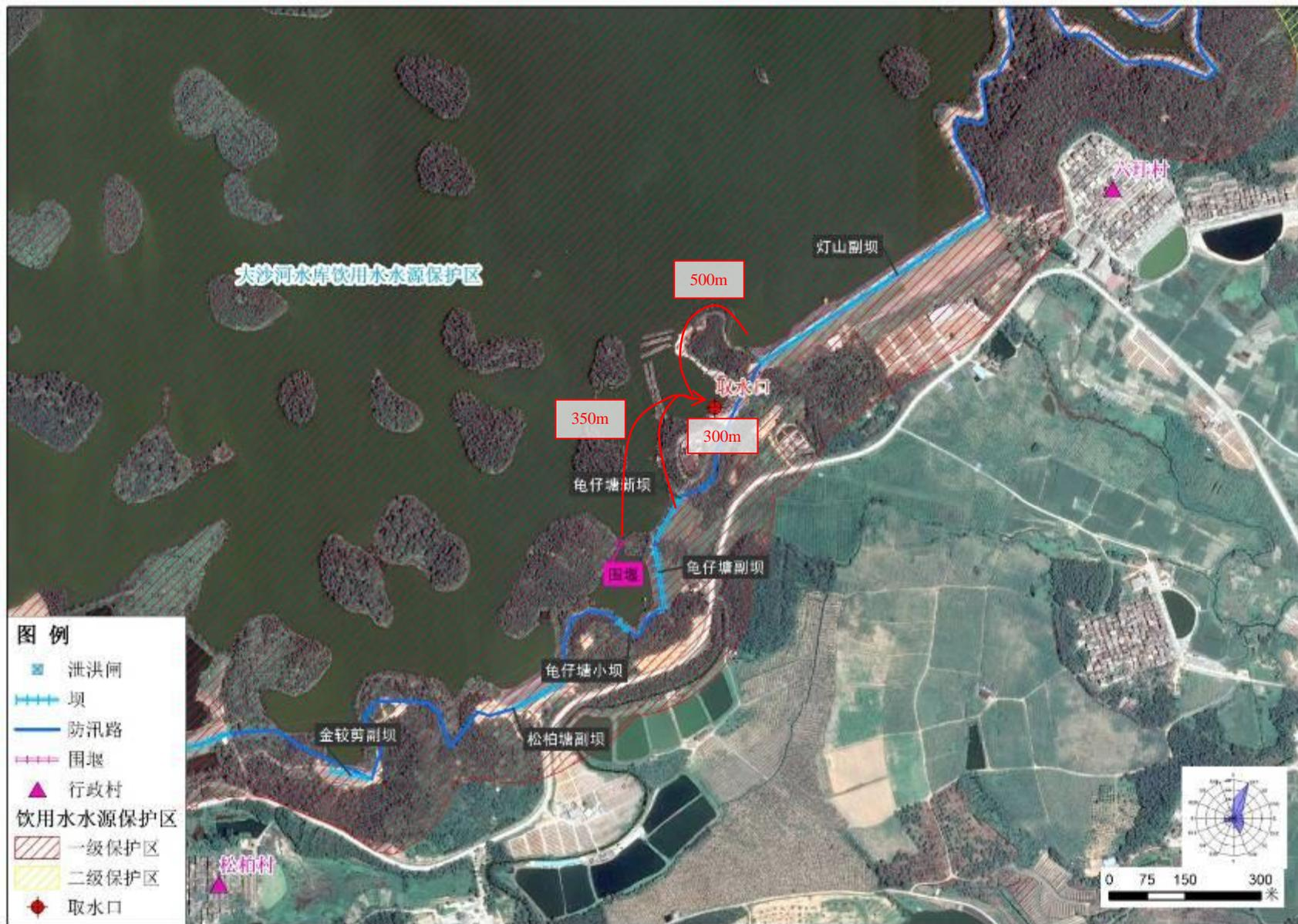
图 6.1-2 工程水下施工与饮用水源一级保护区及其取水口的位置关系
