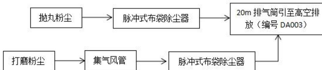
图 5.3-5 项目抛丸粉尘、打磨粉尘治理工艺流程图
