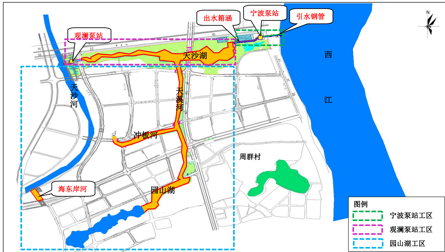
图 3.12-1 项目施工工区分布图
