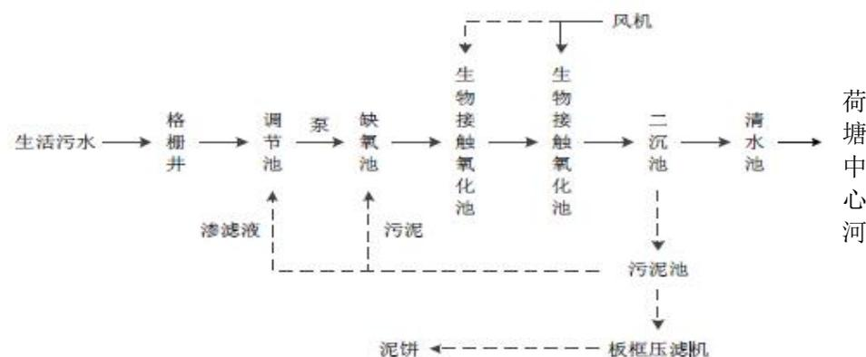
图 4-1 项目生活污水处理工艺流程图
