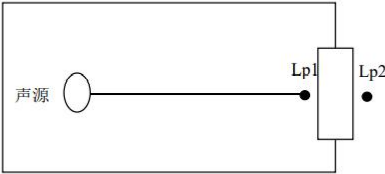
图7-1 室内声源等效为室外声源图例图
