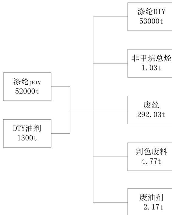
图 2-1 涤纶 DTY 物料平衡图
