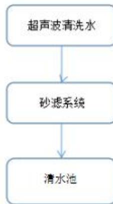
图 4-1 废水处理工艺流程图
