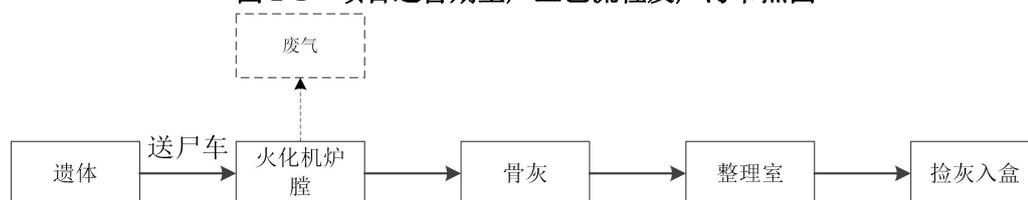
图 2-2 火化机火化尸体运行流程图
