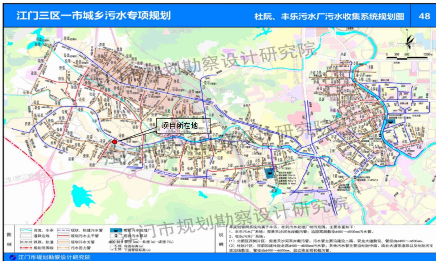
附图8 杜阮污水处理厂纳污管网范围
