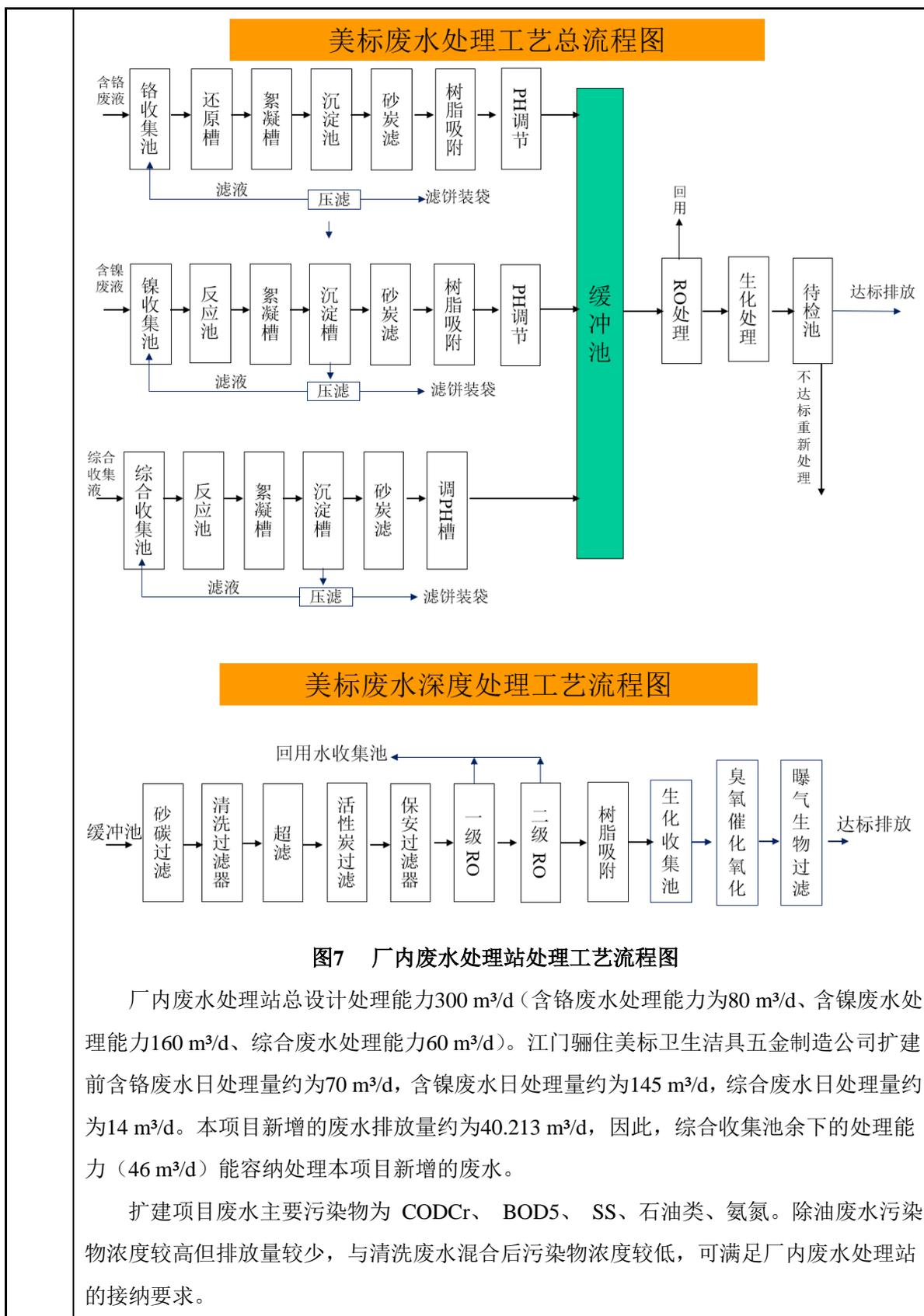
项目废水处理站综合收集池采用生化处理工艺，属于《排污许可证申请与核发技术规范 电镀工业》（HJ 855-2017）表3中的“化学沉淀法处理、生物处理”污染防治措施。
