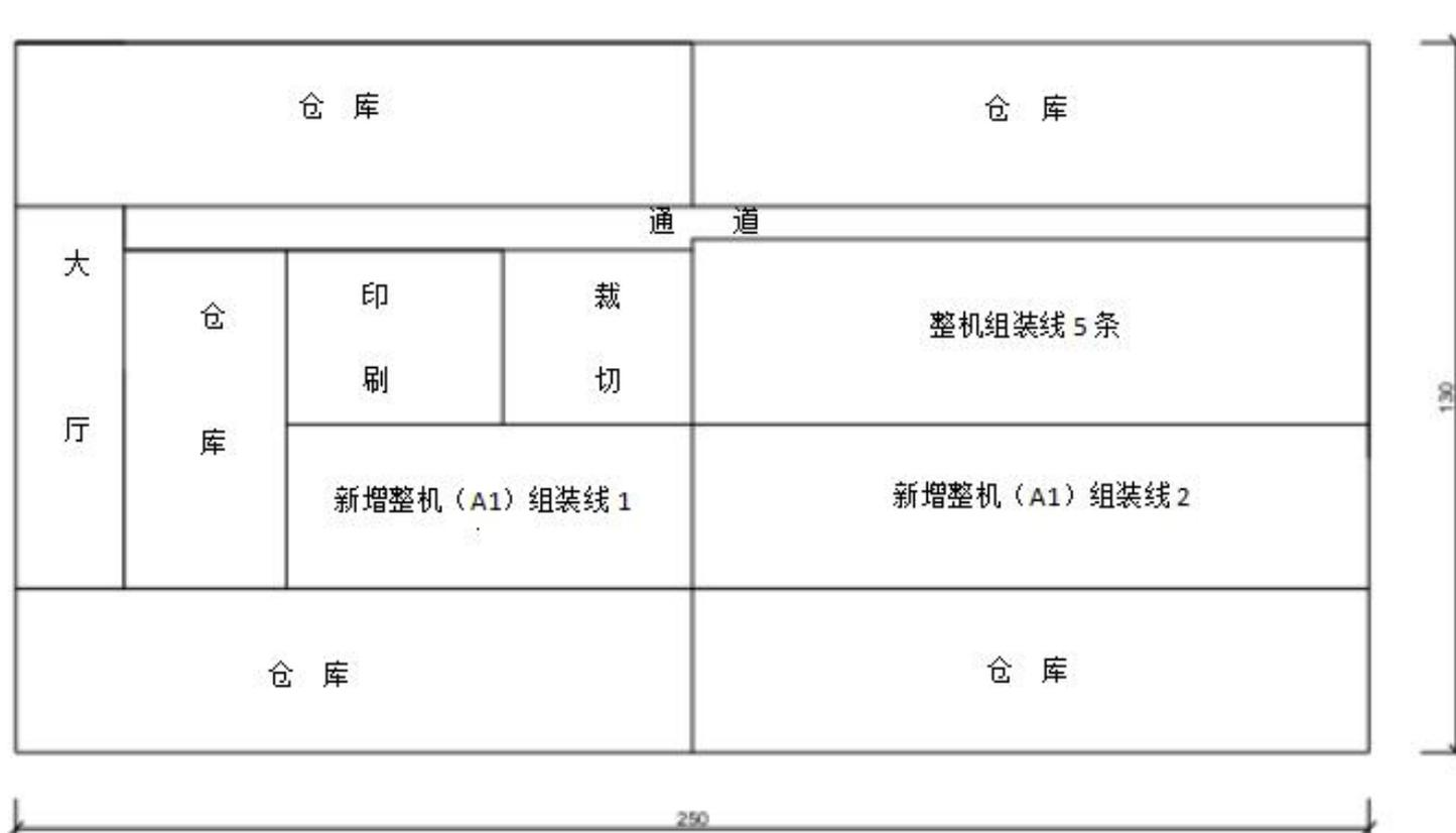
附图 6 整机厂房 2 楼平面布置图
