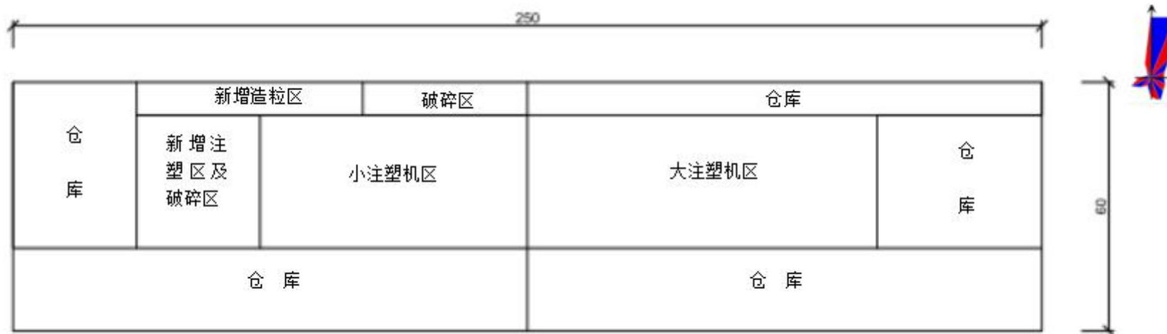
附图5 整机厂房1楼平面布置图
