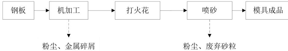
图 2-4 模具生产工艺流程
