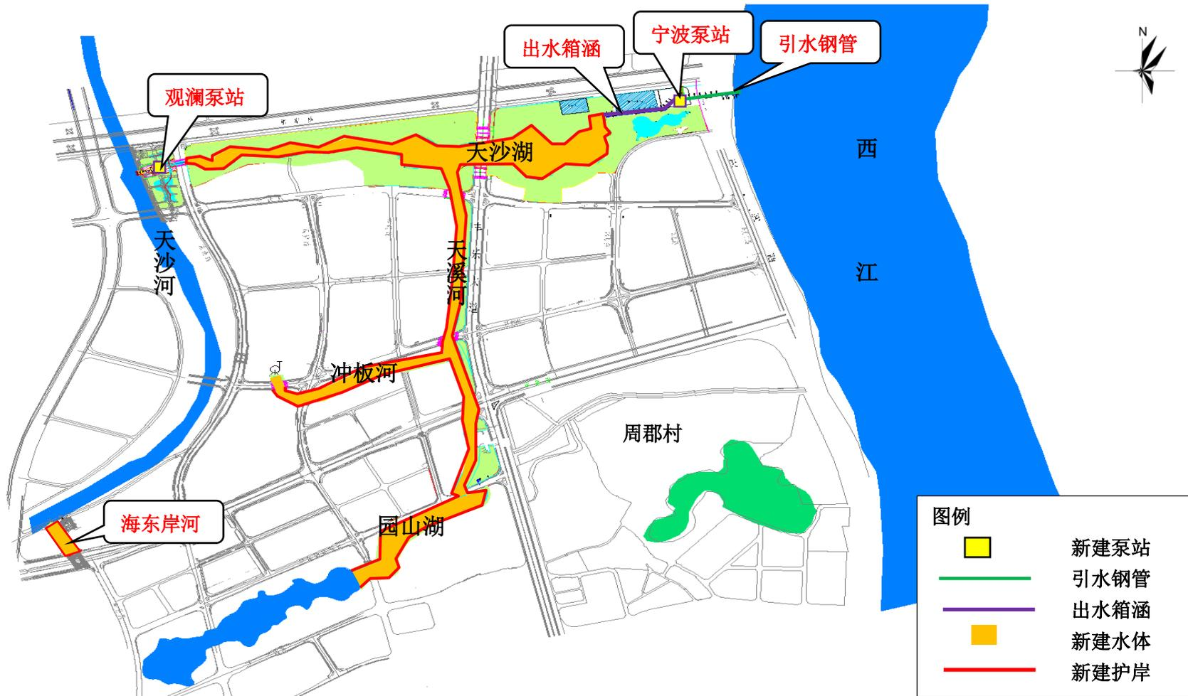
图 3.7-1 项目总平面布置图
