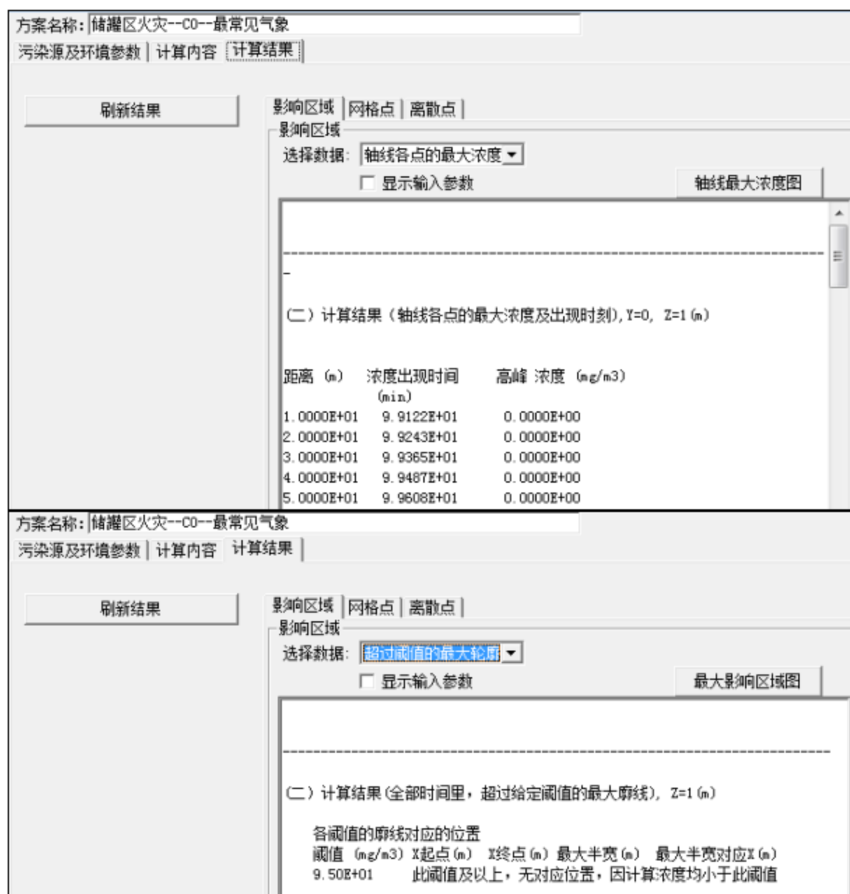
图 5.6-3k 下风向不同距离处储罐区火灾爆炸情况下释放的 CO 的最大浓度值
