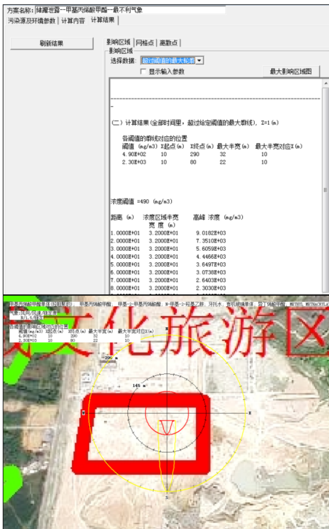
图 5.6-2c 下风向不同距离处甲基丙烯酸甲酯的最大浓度值和超过阈值的最大轮廓图
