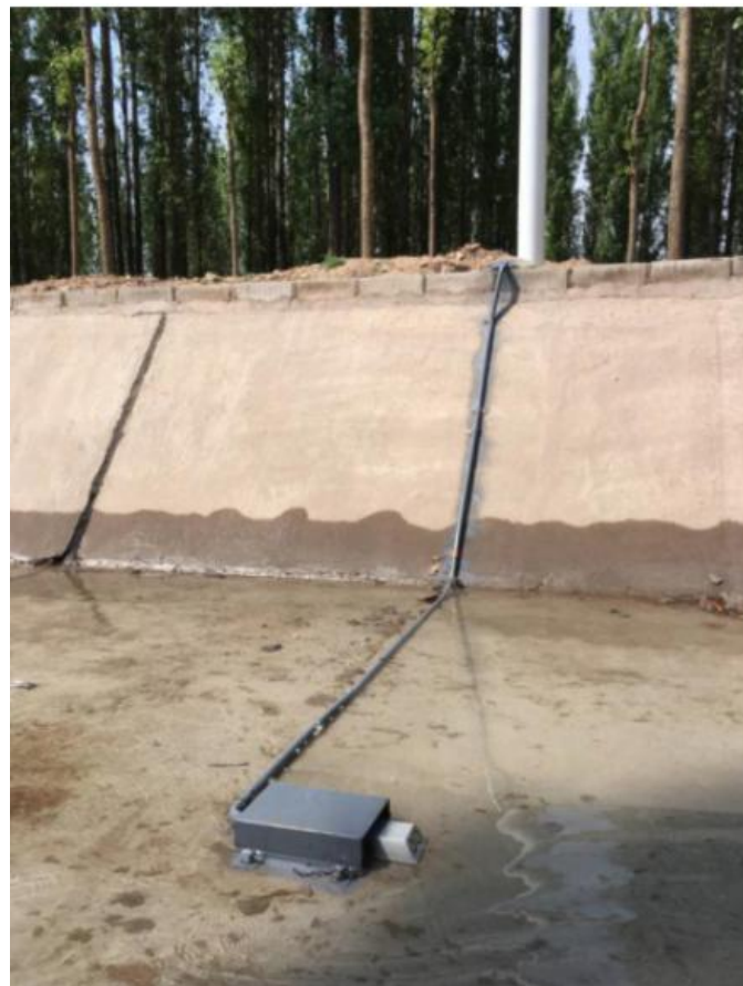
图 4.2.5-2 接触式多普勒超声波流量计安装方式示意图
