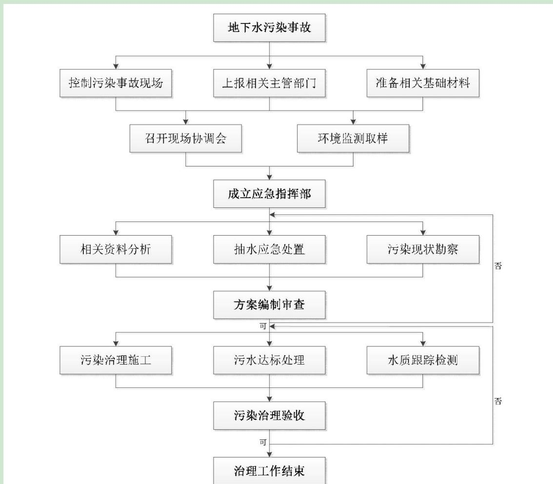
图 6.3-3 地下水污染应急治理程序
