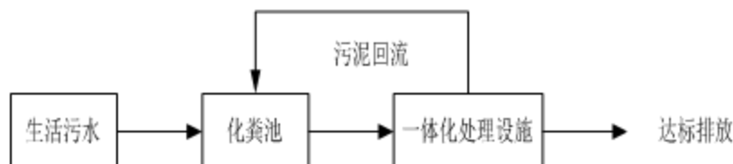
图 4-1 项目生活污水处理工艺流程图
