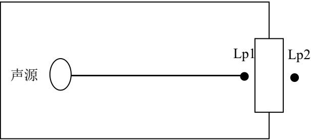
图4-1室内声源等效为室外声源图例图
