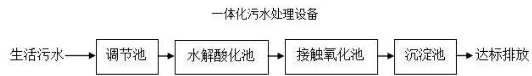
图 4-1 项目生活污水工艺流程图
