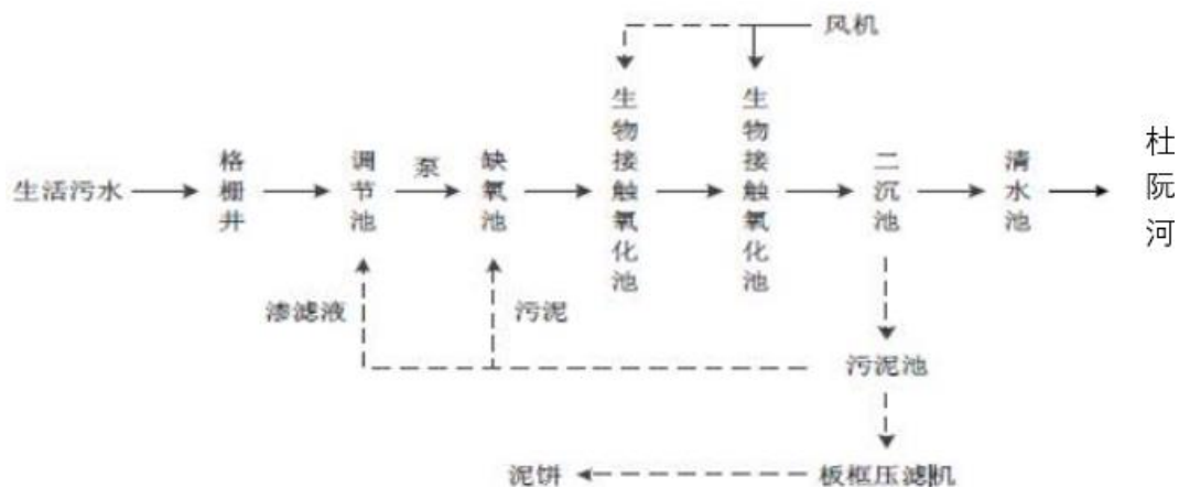
图4-1 项目生活污水处理工艺流程图
