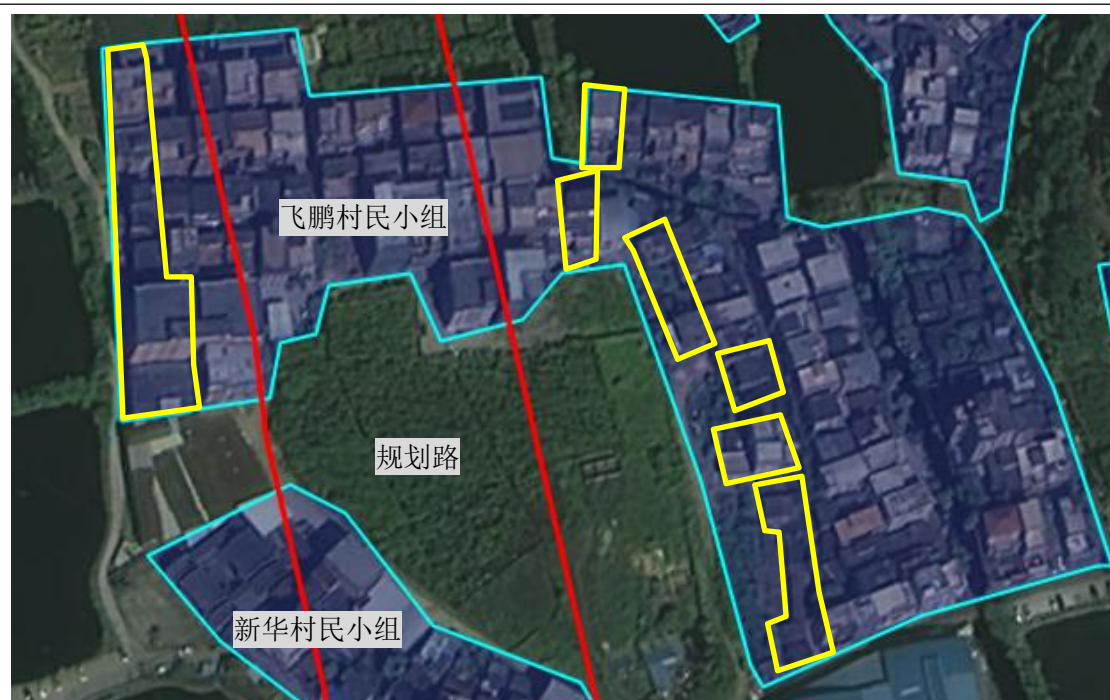
飞鹏村民小组（规划路西侧及东侧） （规划路穿越段、西侧及东侧加装隔声窗之间的房屋均进行拆除）
