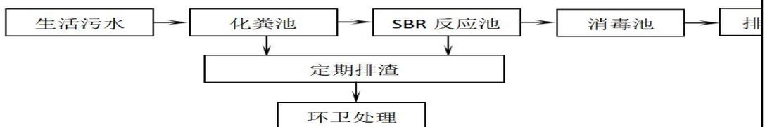
图 4-1 生活污水处理工艺流程简图
