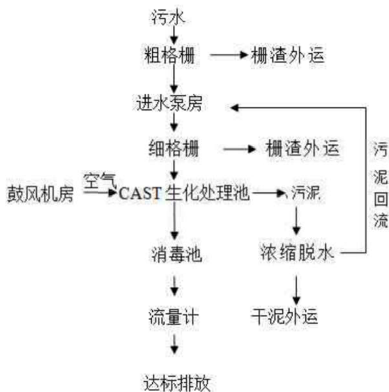
图 6.2.2-1 苍城镇污水处理厂工艺流程图
