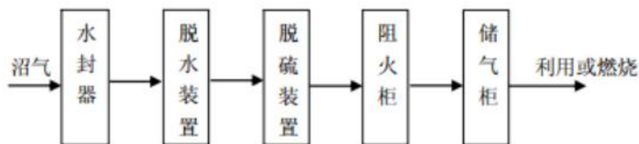
图 6.3-1 沼气净化器的工艺图
