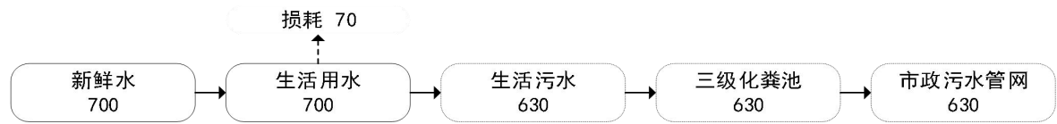
图 2-1 项目改扩建前水平衡图 (m³/a)
