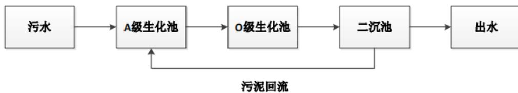
图 4-1 一体化污水处理设备工艺流程图
