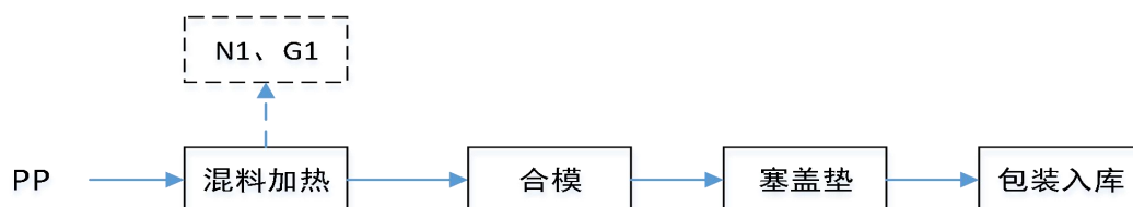
图 2-6 PP 塑料瓶盖生产工艺流程图
