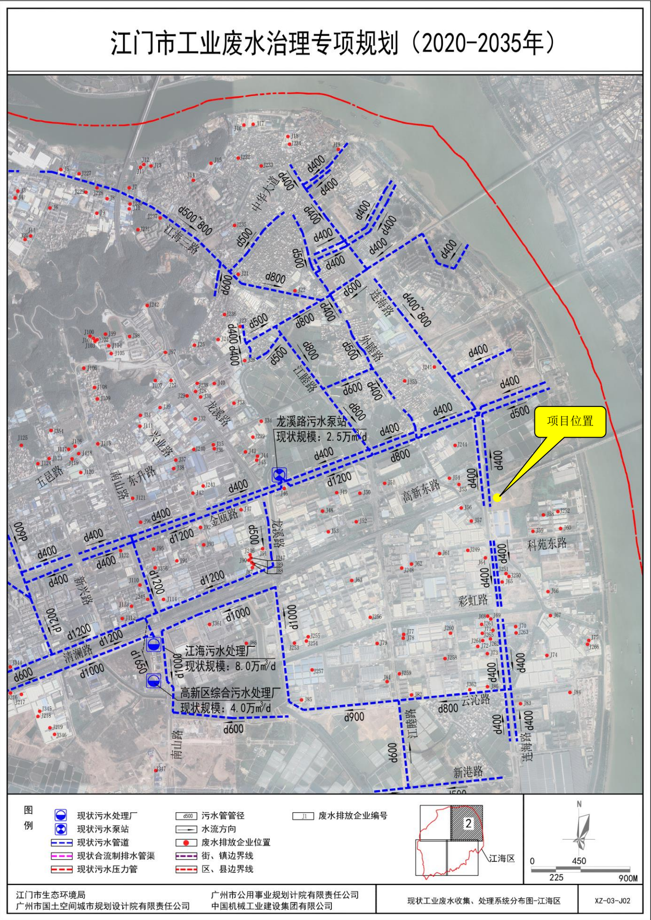
附图 10 江海区污水处理厂纳污管网图
