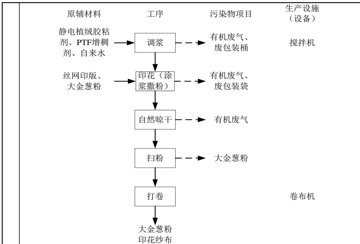
图2-6 大金葱粉印花工艺流程图
