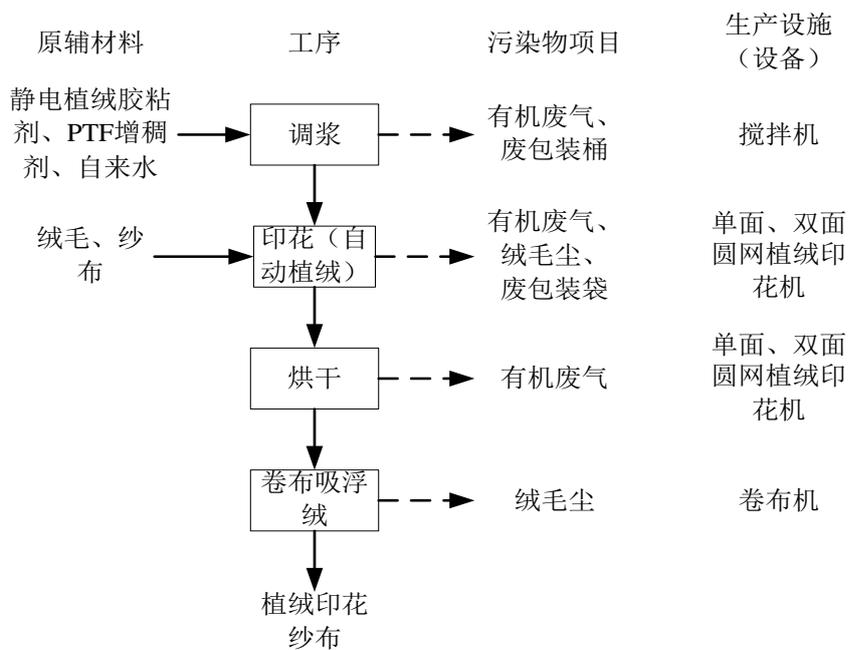
图2-3 自动植绒工艺流程图
