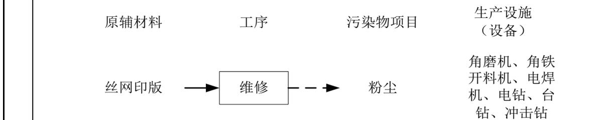
图2-7 丝网印版维修工艺流程图
