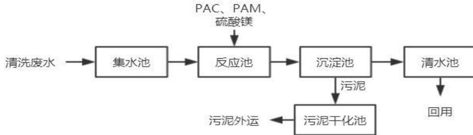
图 4-1 项目生产废水处理工艺流程图
