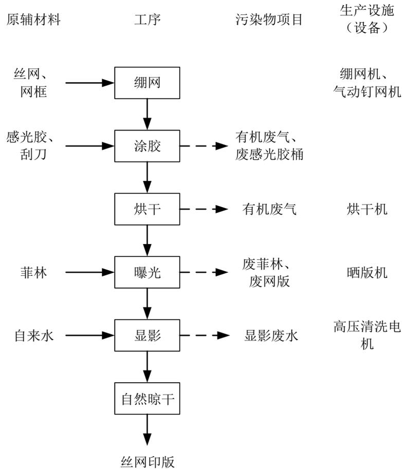
图2-2 项目丝网印版生产工艺流程图
