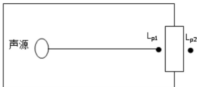
图 7.4-1 室内声源等效为室外声源图例
