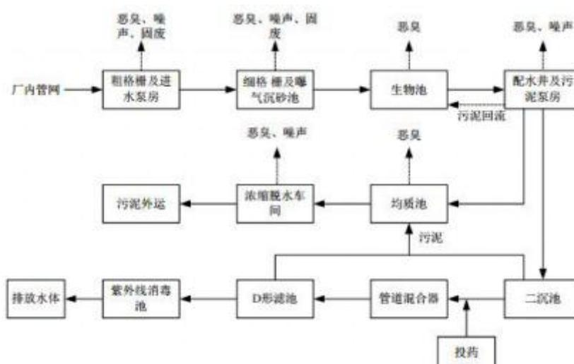
图 4-4 污水处理厂工艺流程图
