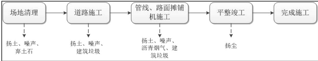
图 2-6 道路施工工艺及产污环节图
