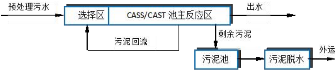
图 3.2-1 CASS/CAST 工艺基本流程
