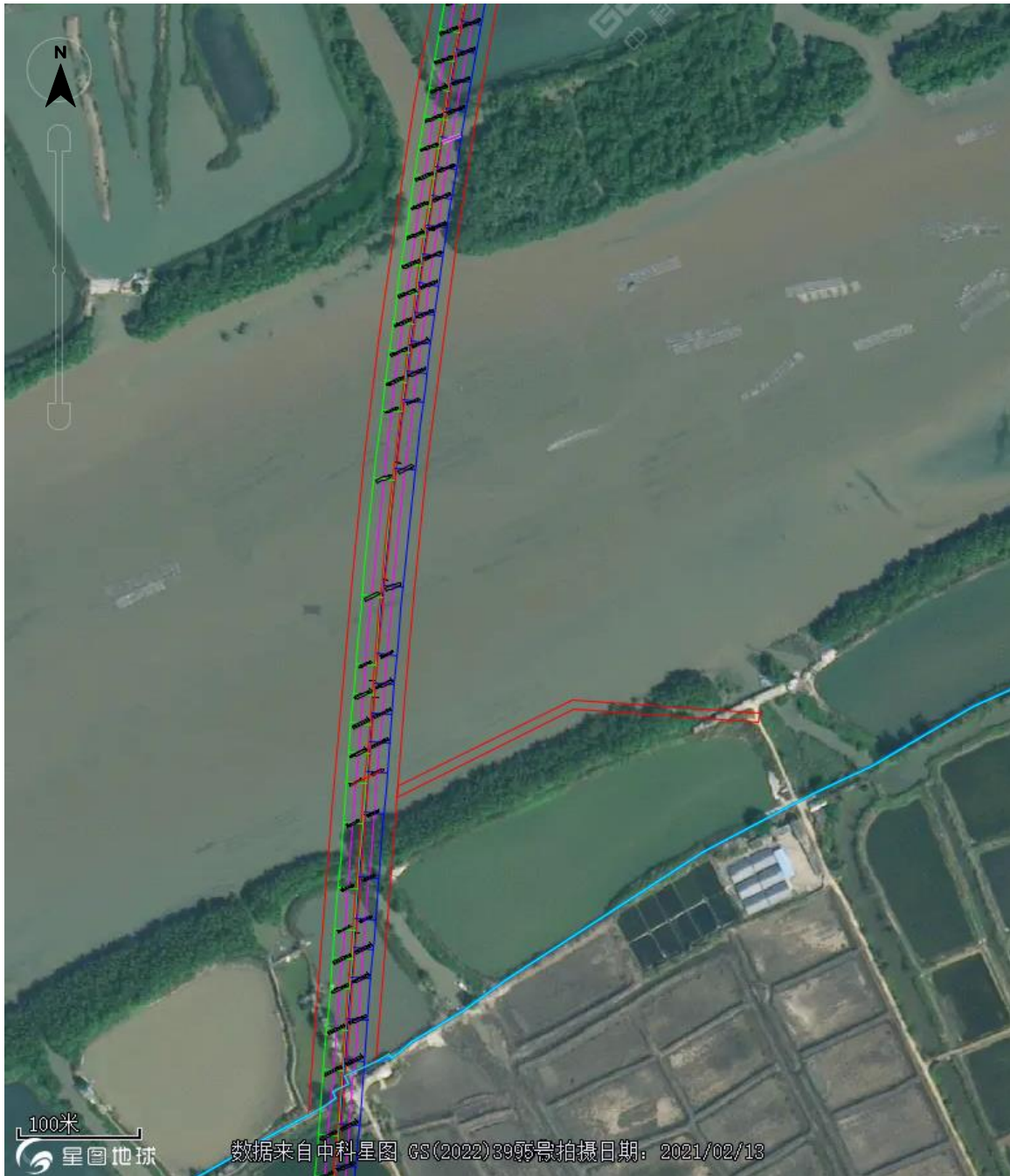
图 4.1-19 过水断面桥墩布置图
