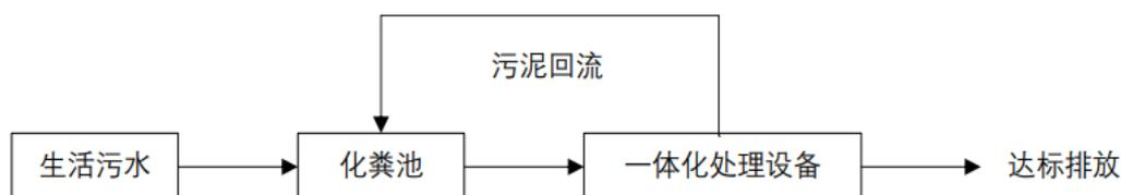
图 4-1 项目生活污水处理工艺流程图
