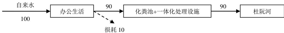
**图 2-1 项目水平衡图 (单位: m<sup>3</sup>/a)**
