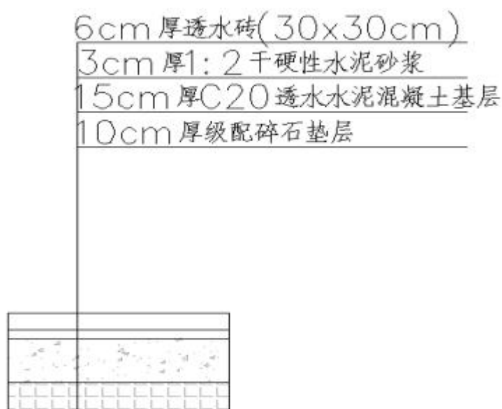
图2-28 非机动车道路面结构示意图
