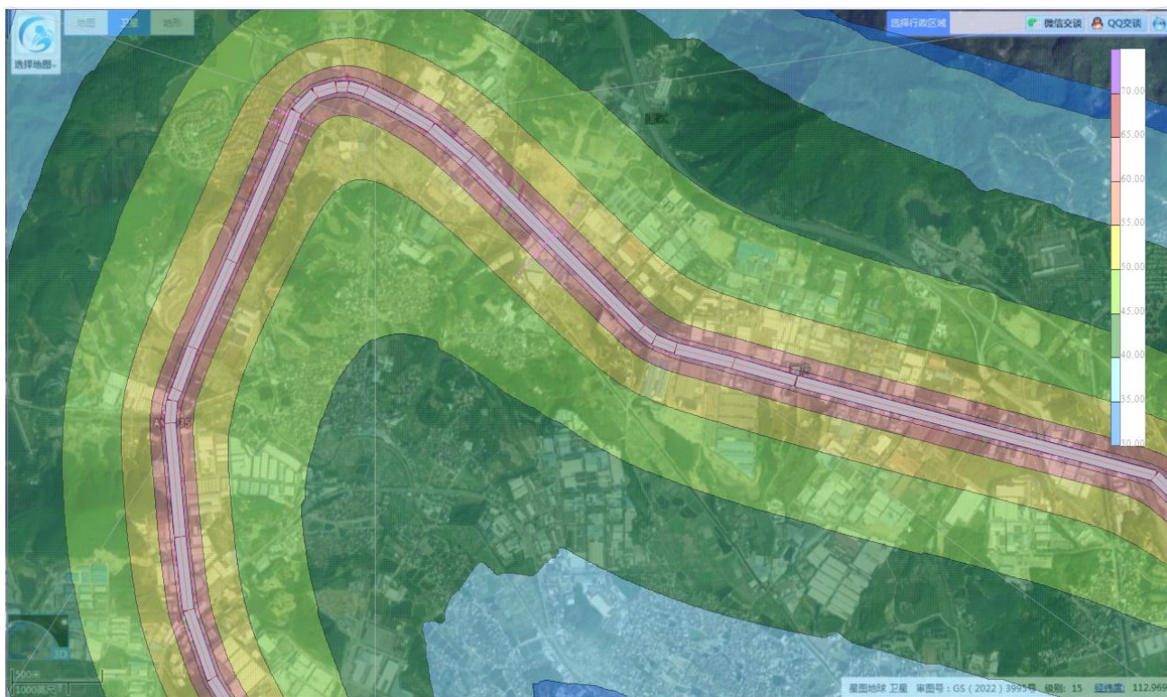
图 4.2-18 中期（2034）项目道路两侧昼间交通噪声水平衰减等声级线图
