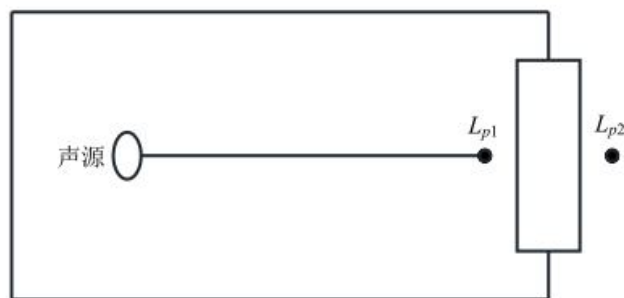
图 4-3 室内声源等效为室外声源图例
