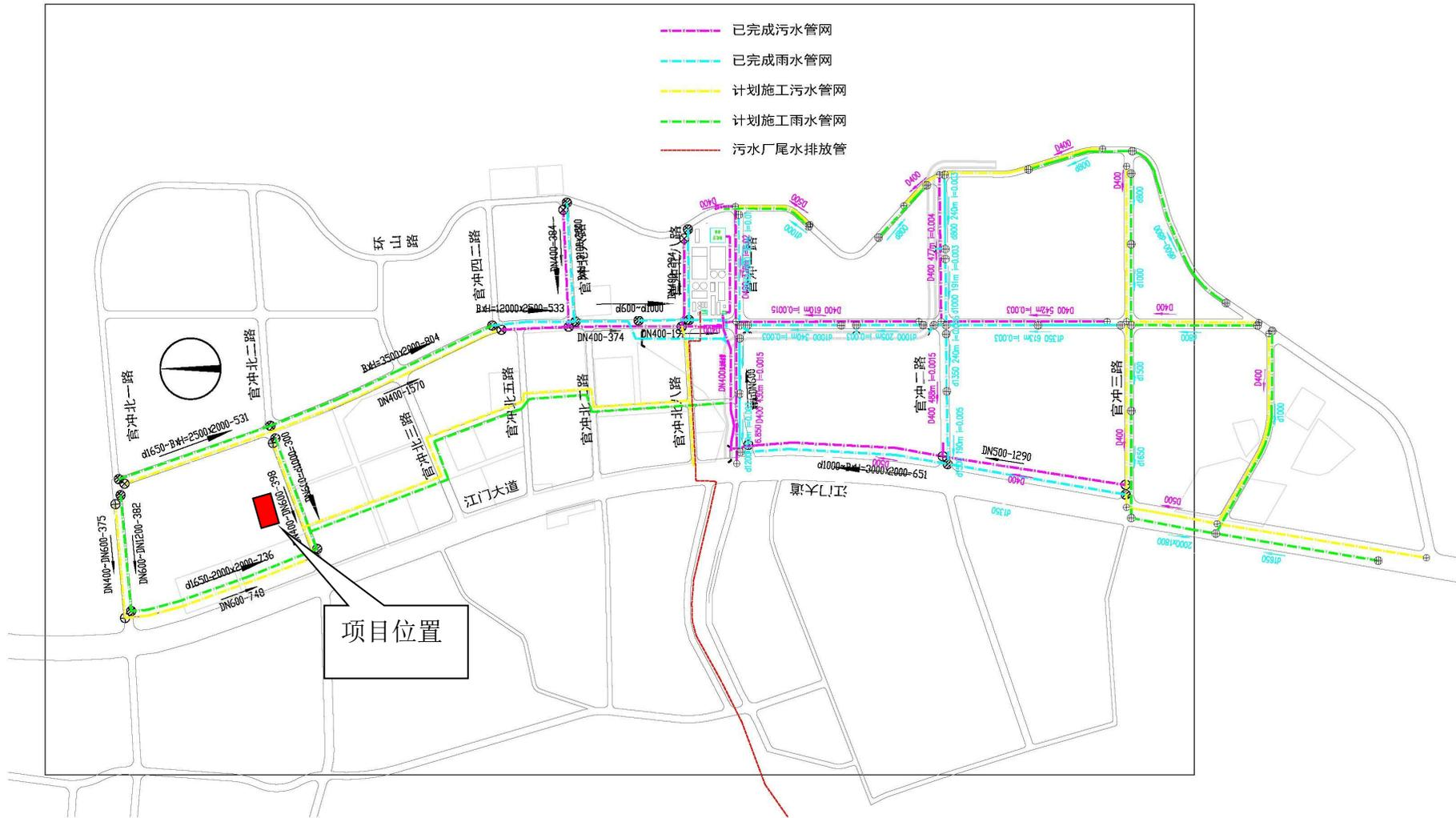
图 3.1-3 项目雨污管网图
