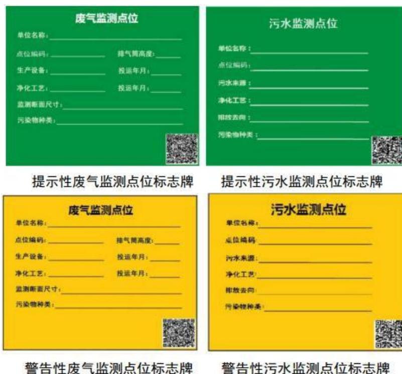
(2) 监测点位标志牌的技术规格、信息内容及点位编码应符合《固定源废气监测技术规范》（HJ/T397-2007）附录规定。
