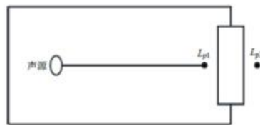
图4-2 室内声源等效为室外声源图例
