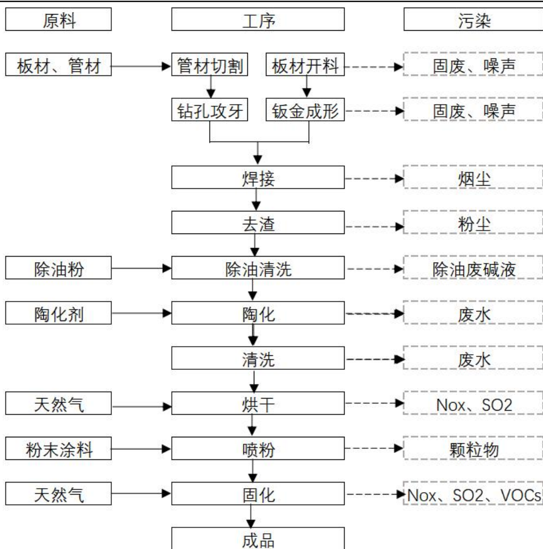
图 2-5 五金件生产流程图
