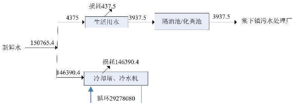
图 2. 项目水平衡图（远期）
