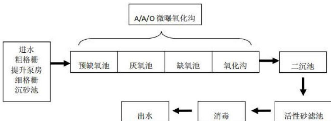
图 4-1 新美污水处理厂处理工艺流程图
