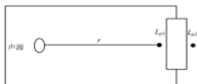
图1. 室内声源等效为室外声源图
