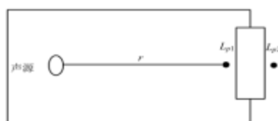
图1. 室内声源等效为室外声源图
