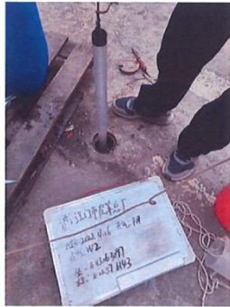
9: W2 地下水采样口
