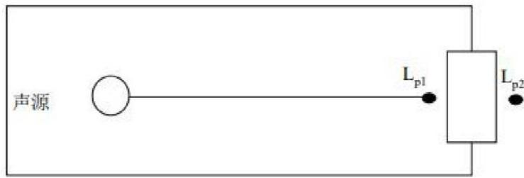
图 4-3 室内声源等效为室外声源图例
