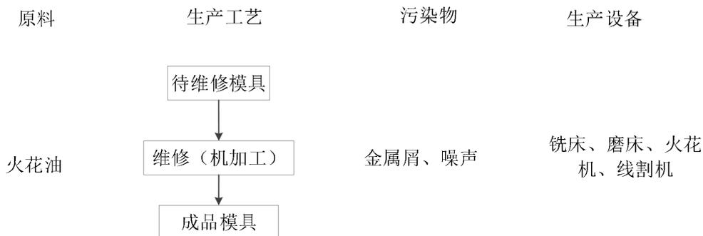
图 2-3 模具维修工艺流程图
