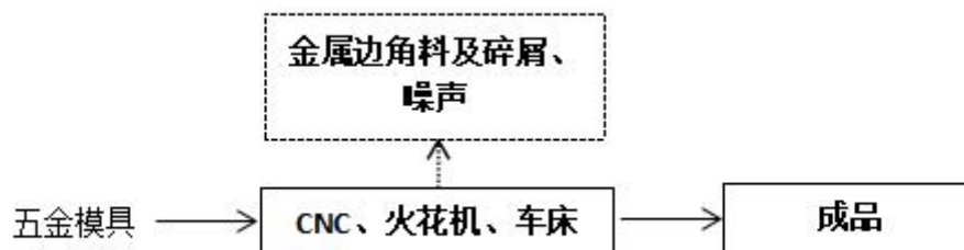
图 2-3 五金模具加工工艺流程图
