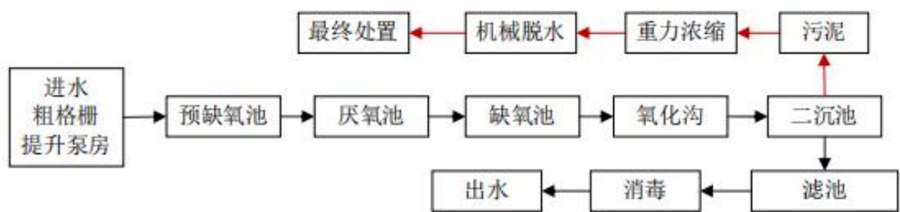
图2 新美污水处理厂水处理工艺流程图
