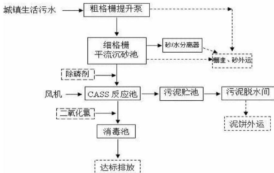
表 28. 水口镇污水处理厂处理工艺流程图
